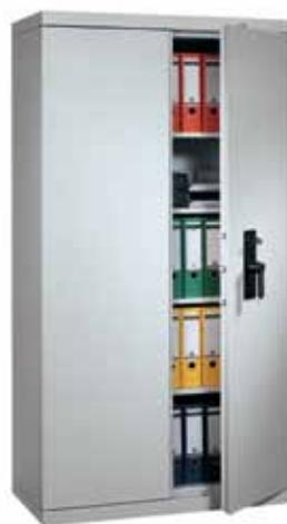
V nižji protipožarni razred spadajo omare, ki so izdelane v skladu s standardom **DIN 4102**, ki ga na tem področju uporabljamo že več desetletij. To pomeni, da **so izdelane iz dveh ali treh plasti pločevine**, vmesni prostor pa je zapolnjen z **izolacijskim materialom**. Papir je v tem primeru pred ognjem varen **približno 30 minut**.
